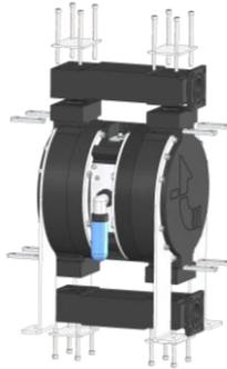
Entfernen Sie die beiden Brücken durch Lösen der abgebildeten Schrauben u. Gewindebolzen
