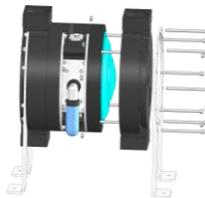
Lösen Sie die Gewindestangen durch Entfernen der entsprechenden Muttern. Achtung: Dadurch verlieren sämtliche Gehäuseteile ihre Verbindung zueinander.
